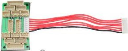
Sans ce boîtier, pour charger plusieurs batteries, il faut utiliser la petite plaque multiprises qui impose un total d'éléments limité à la version du chargeur (6s maxi pour le UNA6 Plus 6S et 9s pour le UNA9 Plus 9S) Le choix de charge est i6s +3s=9s ou 3x3s ou 2x4s ou 4x2s... et ainsi de suite du moment où le total de s ne dépasse pas 9.
