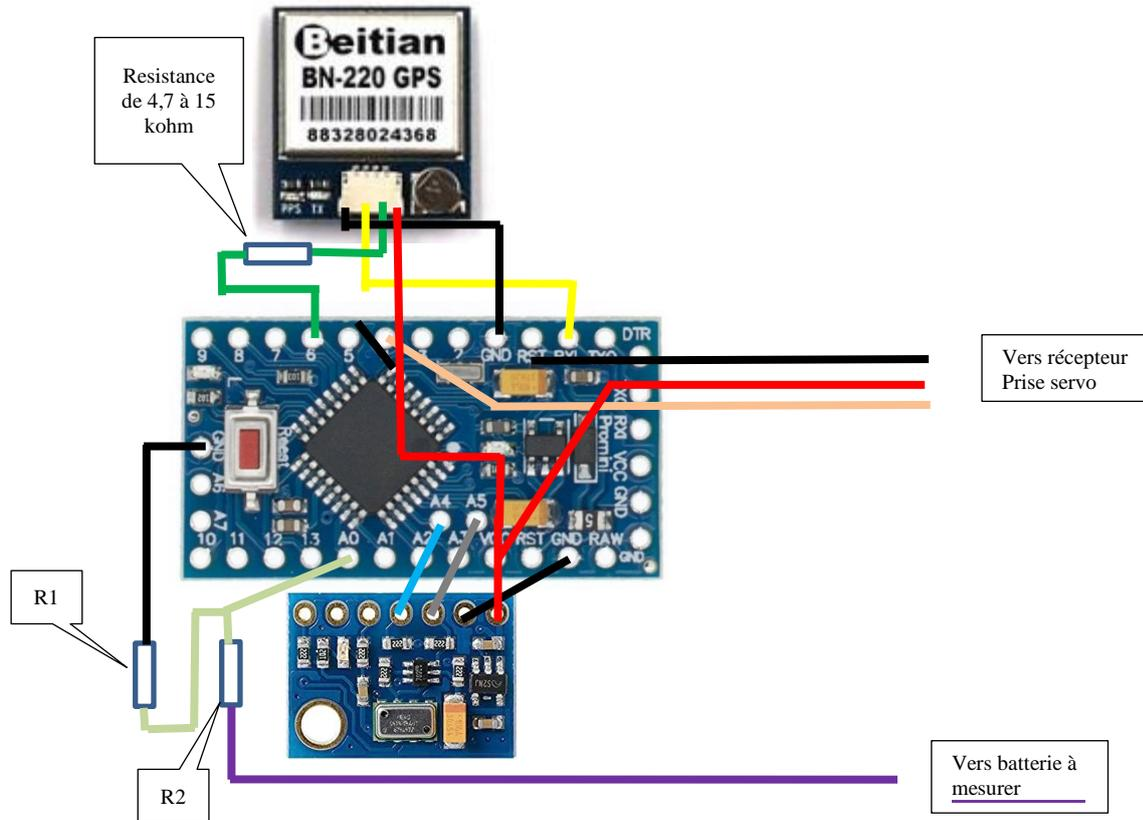
**Attention :** L'alimentation du module doit se faire sur la broche Vcc si le récepteur est alimenté en 5v et sur la broche Raw si le récepteur est alimenté par une tension supérieure.
